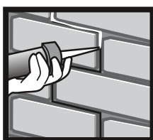
Reboucher les trous de vis et les imperfections au mastic.
