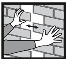
Emboîter le panneau suivant jusqu'à ce que le mastic déborde.
